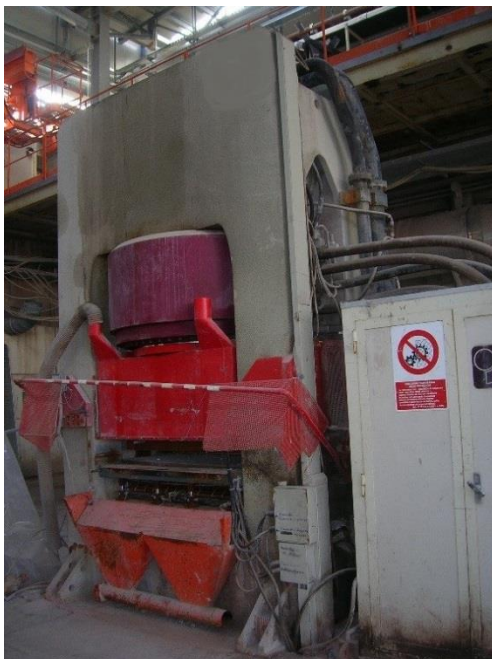
Esempio di una pressa idraulica per ceramica usata, convertita in pressa per pentole dopo completo retrofitting
