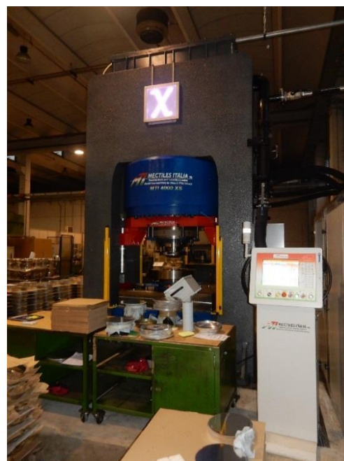
Esempio di una pressa idraulica per ceramica usata, convertita in pressa per pentole dopo completo retrofitting
